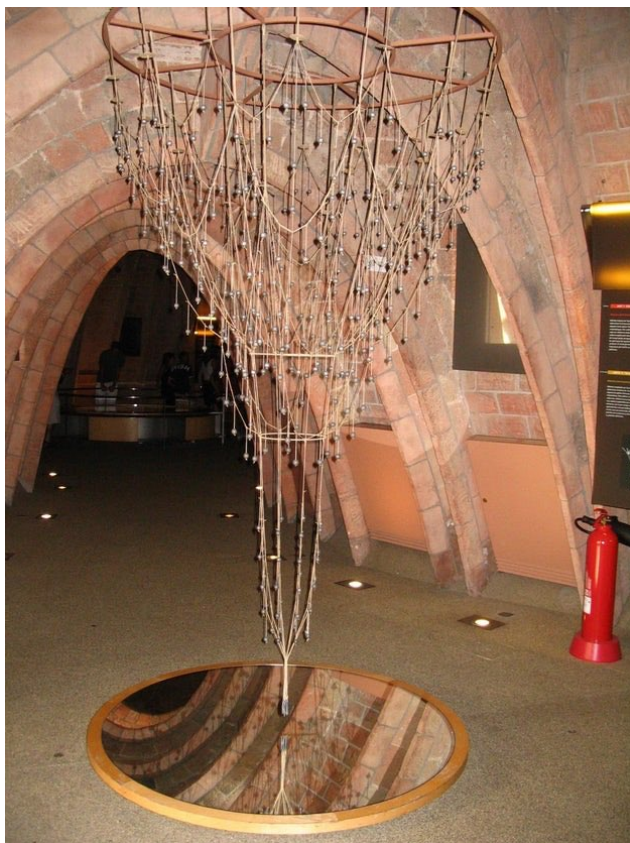
Figura 12: Modelo colgante con pesos distribuidos estratégicamente usado por Gaudí para dibujar los planos de la Sagrada Familia.
