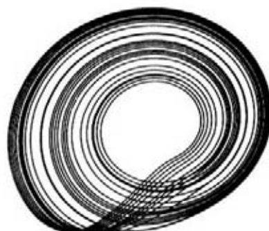
FIGURA 3. Órbita de un punto del atractor de Rössler.
